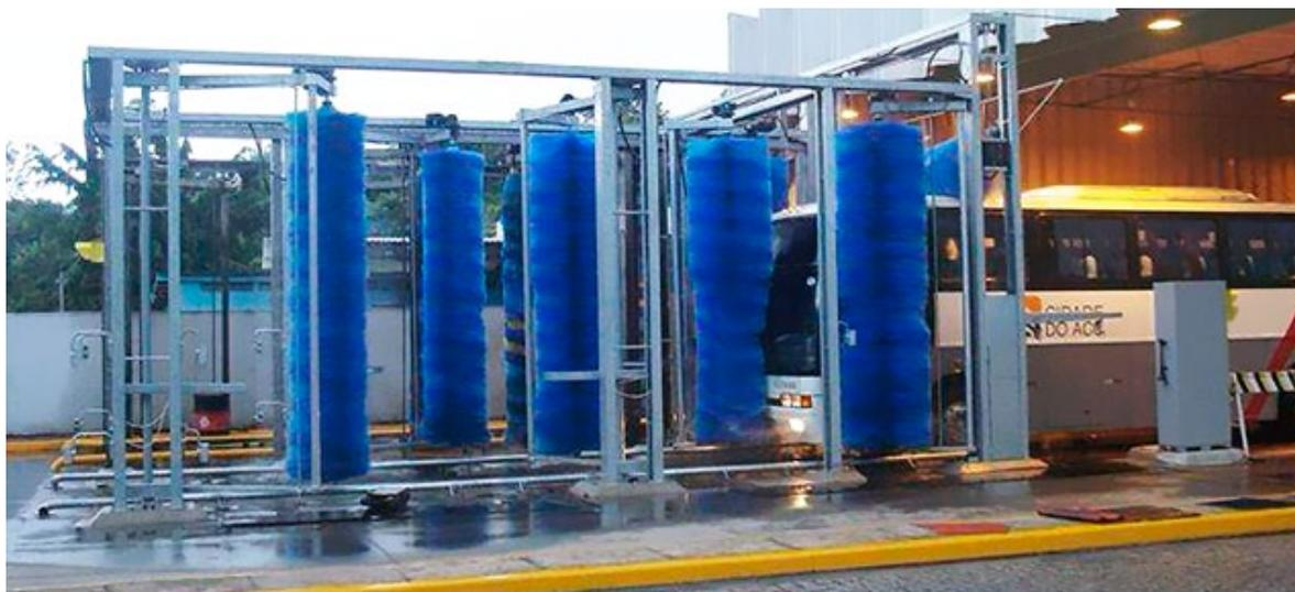
La gamma prevede diverse altezze di lavaggio e un numero di spazzole e accessori in funzione della necessità dell'utente. La struttura può essere adattata a tutti i veicoli di trasporto, compresi i tram o veicoli provvisti di pantografo.
