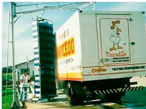
Roll Wash è l'impianto mono-spazzola proposto da Ceccato a funzionamento manuale. Adatto per il lavaggio delle superfici verticali. Altezza di lavaggio 4,10 m. Robusta struttura in acciaio zincato a caldo.
